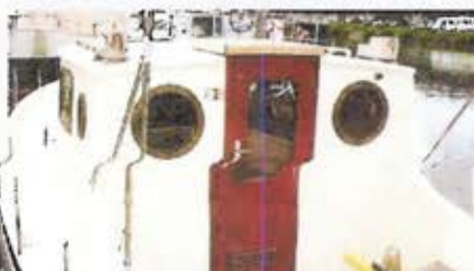
Les 2 hublots ronds permettent au barreur de voir au travers de la cabine en position assise.
